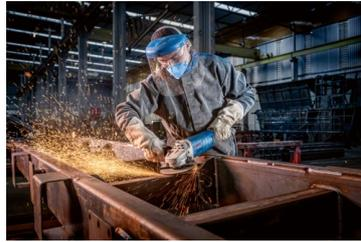
Performante et robuste : meuleuse angulaire de 230 mm avec PROtection switch (interrupteur homme mort) pour une meilleure protection de l'utilisateur. Enlèvement de matière élevé et bonnes performances de tronçonnage et de meulage grâce au moteur de 2 200 W.
