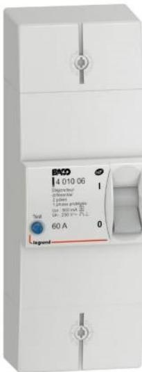
Disjoncteur d'abonné Basse Tension BACO bipolaire 250V pour tarif à puissance limitée (tarif bleu) de 3kVA à 36kVA. Intensité nominale 60A. Coupe et sectionne l'ensemble de l'installation. Protège contre les surcharges et les courts-circuits. Dispose d'un réglage de calibre pour limiter la puissance au contrat souscrit auprès du distributeur d'énergie. Plombable. IP40.
