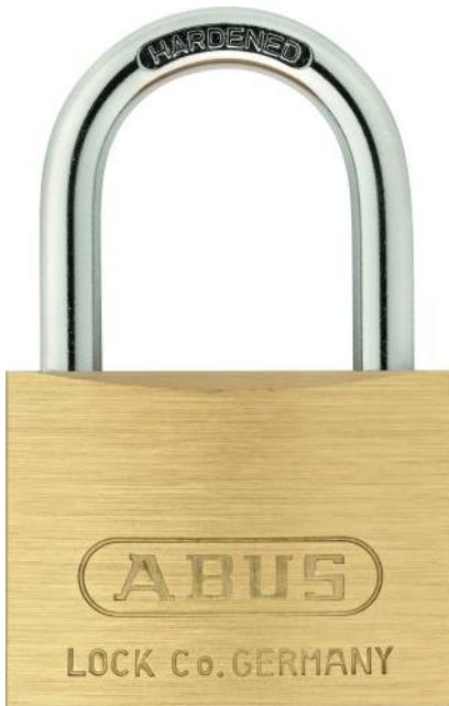
En acier massif. Anse en acier cémenté. Pièces antérieures en matériaux non corrosifs. Cylindre de précision à goupilles. Fermeture automatique en appuyant sur l'anse, sans clé.
