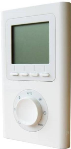
Accessoire standard de régulation pour plancher chauffant. Isolation classe II. Sortie contact inverseur 2A max., 230 V. Action de type 1.C (microcoupure). Régulation de type proportionnelle intégrale (base de temps 15 mn) ou tout ou rien. Fixation murale ou sur boîte d'encastrement. Installation en milieu normalement pollué. IP30.
