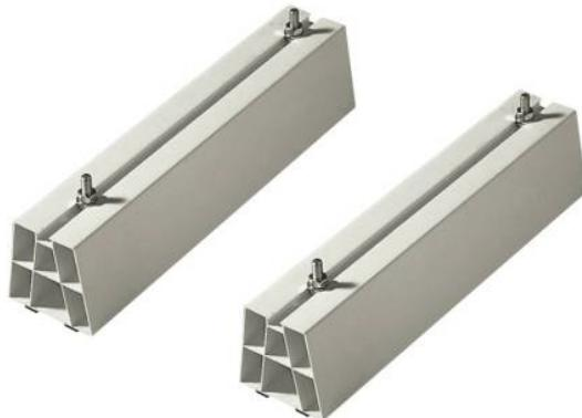
Support blanc en PVC d'une porté de 210kg maxi. Excellente résistance aux températures -20°C + 60°C. Installation facile et rapide. Ajustable à tout type d'unité extérieures (rail de fixation). Kit de visserie inclus, filmé par paire et équipé de patins antidérapants et anti-vibrations.
