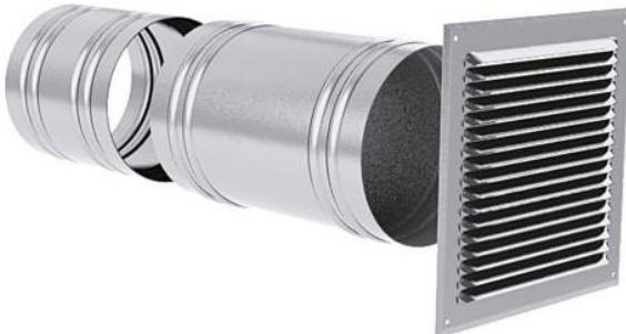
Permet d'assurer la prise d'air neuf ou le rejet d'air vicié en façade dans des installations de ventilation mécanique. Grille aluminium à auvent en façade. L'ensemble constitué du manchon fixe de longueur 250mm et du manchon de réglage de longueur 200mm permet d'assurer la traversée de murs d'épaisseurs 250 à 400mm.
