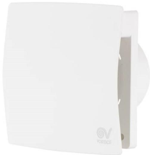
Extracteur permanent hélicoïde électrique monophasé. La pose peut se faire soit au mur, soit au plafond. Corps, grille et façade en plastique ABS. Moteur EC (courant continu) avec contrôle électronique à débit constant. L'hélice est de forme hélicoïde privilégiant un débit constant et un niveau sonore faible. VRE à 2 vitesses par une commande non fournie. Deuxième vitesse temporisée 6min. IP45 et Classe II (double isolation électrique). Homologué CE et construit suivant la norme ISO 9001.
