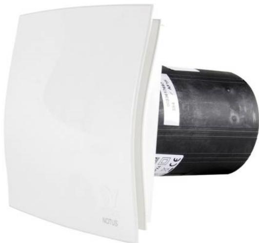
Extracteur permanent hélicoïde électrique monophasé. La pose peut se faire soit au mur, soit au plafond. Fonction hygro. Corps, grille et façade en plastique ABS. Moteur brushless avec commutation électronique (EC) à débit constant. L'hélice est de forme hélicoïde privilégiant un débit constant et un niveau sonore faible. VRN standard, à 2 vitesses par une commande non fournie. IPX4 et Classe II (double isolation électrique). Homologué CE et construit suivant la norme ISO 9001.
