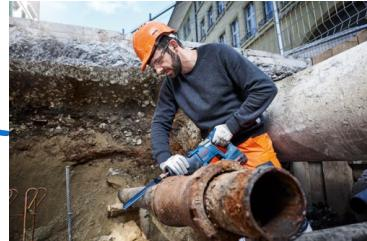
Dure jusqu'à 5 fois plus longtemps qu'une lame Bosch S922AF. Longue durée de vie lors de la découpe de tuyaux et de profilés en métal à paroi d'épaisseur moyenne. Lame épaisse et robuste pour des coupes bien droites. Associe une denture dure et un corps flexible grâce au soudage bi-métal. Section de denture courbe pour un meilleur contact. Géométrie de la denture 3x3 pour une coupe efficace.
