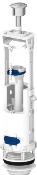
Double chasse 3/6L. Poussoir. Mécanisme à biellette et étrier. Pour trou de couvercle : 18, 40, 50 mm. 1/2 chasse ajustable. Résiduel ajustable. Trop plein ajustable télescopique. Joint silicone. Garantie 10 ans.
