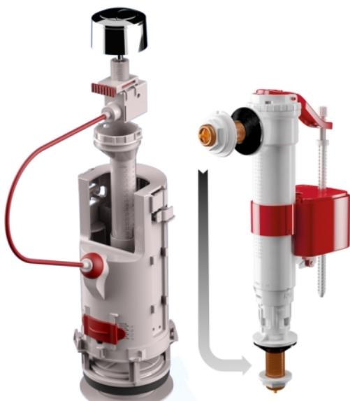
Mécanisme DUAL 6 : double chasse, poussoir, mécanisme à câble, pour trou de couvercle : 6, 18, 40, 50 mm, 1/2 chasse ajustable, résiduel ajustable, trop plein ajustable télescopique et joint silicone. Robinet universel SX : tube de remplissage télescopique, type d'alimentation latérale ou basse, raccordement 3/8 laiton, silencieux Classe 1, fermeture hydraulique, ouverture du robinet différée. 2 à 3m<sup>3</sup> d'économie d'eau par an pour une famille de 4 personnes et filtre de protection.
