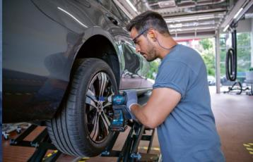
Boulonneuse légère et compacte avec modes paramétrables pour des usages multiples. Deux modes de vissage par défaut pour des usages multiples. Possibilité d'adaptation et de personnalisation de chaque mode via l'application Bosch Toolbox. Performances élevées avec un couple de serrage de 330 Nm et un couple de décollement de 560 Nm. Trois réglages de vitesse/couple au choix pour une plus grande souplesse d'utilisation et une meilleure maîtrise.
