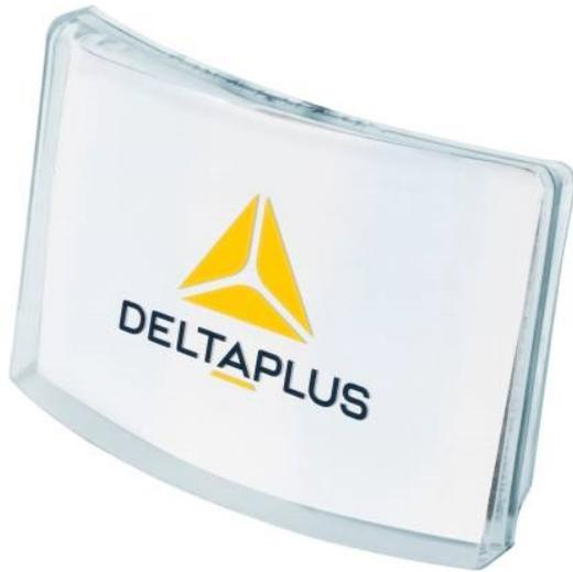
Porte-badge amovible compatible avec l'ensemble des casques de sécurité de la gamme Delta Plus (ZIRCON, QUARTZ, DIAMOND, GRANITE, ONYX). Dimensions maximales du badge : 92x62mm. Polycarbonate avec scratch adhésif.
