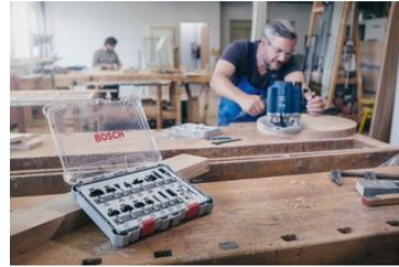
Le kit de fraises permet d'exécuter des coupes précises pour différentes applications, parfait pour les menuisiers, les charpentiers, les décorateurs d'intérieur et les professionnels de la construction. Les arêtes de coupe en carbure procurent une longue durée de vie. Différentes géométries de coupe permettent de fraiser un large éventail de profilés dans divers matériaux. Les fraises sont conçues pour être utilisées dans du bois tendre, du bois dur et du bois composite. Queue de 8mm.
