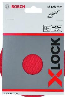
Le plateau de ponçage X-LOCK auto-agrippant est idéal pour les travaux de ponçage avec du papier abrasif tous grains. Son plastique thermostable le rend résistant aux températures élevées et à la casse. Son profil d'arête spécial permet de changer facilement le papier abrasif. Il est facile et rapide de remplacer les plateaux de ponçage avec le système sans clé X-LOCK. Convient aux meuleuses angulaires X-LOCK.
