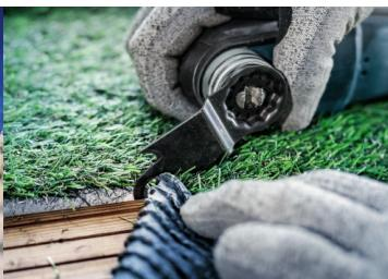
Conçue pour couper la moquette. Découpe rapide de la moquette et d'autres matériaux souples. Bord de couteau tranchant pour les matériaux souples.
