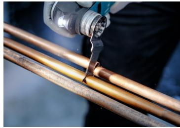
Longue durée de vie lors de la coupe de métal tendre. Associe une denture dure et un corps flexible grâce au soudage bi-métal. Enduit pour une durée de vie accrue.
