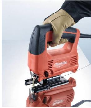
Légère et compacte à mouvement pendulaire pour la coupe de panneaux et de bois massif de faible section. Semelle s'inclinant jusqu'à 45° des deux côtés (coupes en biais). Interrupteur à variateur de vitesse. Canal d'extraction de poussières intégré pour connection à un aspirateur. Poignée ergonomique Soft Grip pour une meilleure prise en main. Action rotative.
