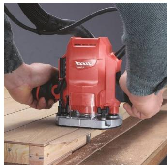
Légère, pour les usinages décoratifs et l'encastrement de ferrures simples. Verrouillage aisément de la profondeur plongée sans lâcher les poignées. Butée très accessible à 3 positions ajustables réglant la profondeur de la plongée. Prise en main confortable et revêtement anti-dérapant: Soft Grip.
