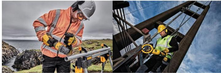
Plus de 1 000 coupes. Lame Extreme Diamond Edge composée de diamants de coupe de métal liés sur la surface du disque à l'aide d'une technologie exclusive. Composée en acier plein réduisant significativement le risque de rupture. Contrairement aux lames abrasives collées, la lame Extreme Diamond Edge n'a pas de durée d'expiration à condition d'être rangée dans les conditions appropriées.
