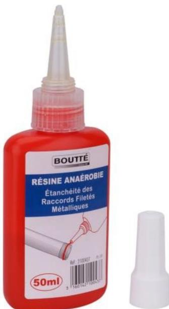
Pour l'étanchéité des connecteurs métalliques filetés des conduites d'eau, de gaz et raccords hydrauliques ou pneumatiques. Produit d'étanchéité anaérobie monocomposant, à haute viscosité et à résistance moyenne. Le produit durcit lorsqu'il est confiné en l'absence d'air entre des surfaces métalliques étroitement ajustées et empêche le desserrage et les fuites dues aux chocs et aux vibrations.
