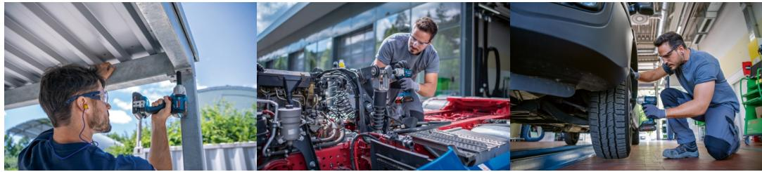
Facilite le travail avec des modes paramétrables pour des vissages maîtrisés. Deux modes de vissage par défaut pour des vissages maîtrisés. Possibilité d'adaptation et de personnalisation de chaque mode via l'application Bosch Toolbox. Performances élevées avec un couple de serrage de 450 Nm et un couple de décollement de 800 Nm. Trois réglages de vitesse/couple au choix pour une plus grande souplesse d'utilisation et une meilleure maîtrise.
