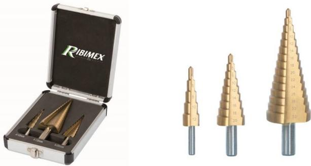
Forets étagés en acier HSS plaqué titane pour une résistance accrue. Spécialement étudiés pour travailler les matériaux de faible épaisseur (5 à 7 mm selon les modèles) ou d'effectuer des avant-trous. Ils permettent des perçages rapides et progressifs à différents diamètres. Capables de percer dans la plupart des matériaux : métal, bois, plastique, tôle...
