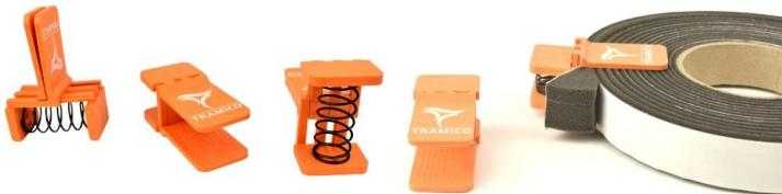
La pince Compriband est fabriquée à partir de polyamide armé de fibre de verre. Elle permet de maintenir comprimés les rouleaux de mousse imprégnée après ouverture en bloquant leur expansion. Évite les pertes de mousse imprégnée des rouleaux entamés. Gain de temps.
