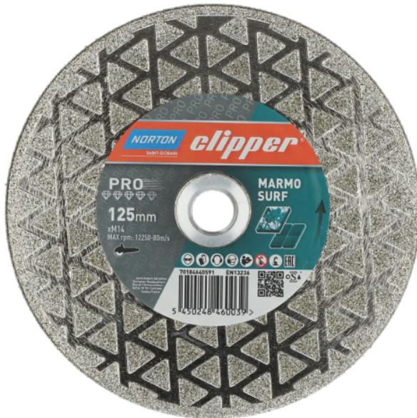
Idéal pour couper et meuler la pierre naturelle. Bord électrolytique continu, pour couper et meuler en douceur. Peut s'utiliser en remplacement d'une meule à disque diamant et d'une meule boisseau. Equipé d'une flasque en aluminium. Pour la pierre naturelle, granit, marbre, carreaux, tuiles de toit, plastiques, résine et fonte ductile.
