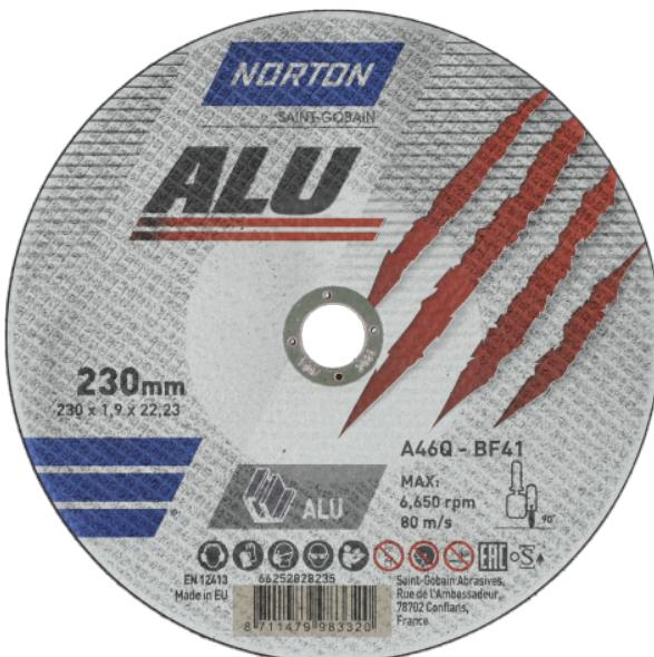
Grain et liant spécialement conçus pour le travail de l'aluminium et métaux non-ferreux. La meule ne se charge pas. Pour le tronçonnage de pièces de fortes épaisseurs, nous vous recommandons la spécification A46N. Evite le glaçage de la meule, pour un travail rapide, facile et confortable sur tous les matériaux non-ferreux.
