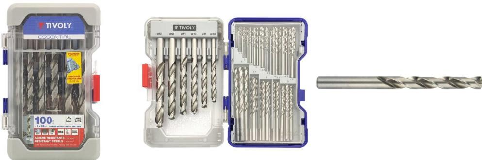
Foret HSS taillé meulé pour le perçage des aciers et des aluminiums. Perçage aisement grâce à l'affûtage auto centrant pointe en croix. Spécial aciers et aluminiums. Perçage rapide. Usage polyvalent. Auto-centrage de la pointe. Queue cylindrique. Goujure type N à 30°. Pointe 118°. Pour les usages généraux dans l'acier jusqu'à 950 N/mm<sup>2</sup>, les fontes et les aluminiums.
