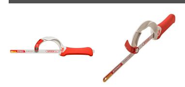
Système de blocage de la lame par levier. Idéal pour les coupes à ras des vis affleurantes et les coupes de précision en tirant. Alliage d'Aluminium, très légère, poignée confort. Livrée avec une lame Erko SpeedFlex.
