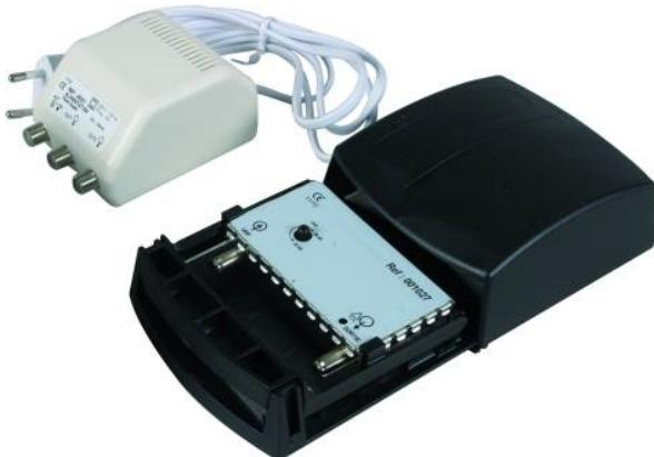
Ce kit préamplificateur permet d'amplifier votre signal d'antenne directement sur le mât d'antenne. Il est constitué d'un préamplificateur étanche et d'une alimentation 220V d'intérieur. Le préamplificateur est alimenté par l'alimentation au travers du câble coaxial.
