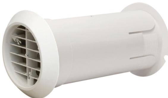
Le KTM 100 est compatible avec l'ensemble des extracteurs de diamètre 100mm. Ses dimensions sont ajustables et son montage en traversée de mur peut se faire sur une épaisseur de mur pouvant aller jusqu'à 390mm. Le kit est installé par l'intérieur du logement, après un carottage (diamètre 117mm), et évite ainsi la pose d'un échafaudage en façade. Une fois le tube positionné, il suffit de pousser la grille par l'intérieur du conduit, qui se déploie avec sa collerette d'étanchéité.
