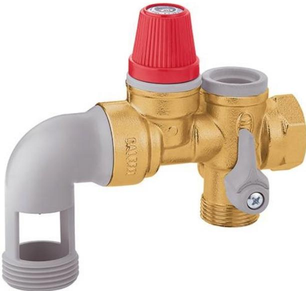
Groupe de sécurité horizontal laiton Thermador Caleffi. Il protège les chauffe-eau jusqu'à une puissance de 10 kW. Pression de tarage de la soupape de sécurité : 7 bar. Pose d'un entonnoir siphon obligatoire.
