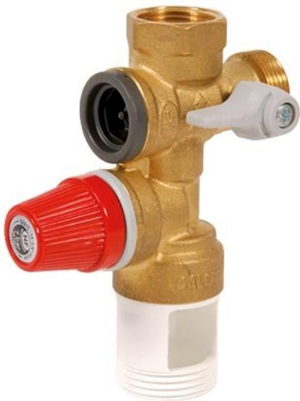
Groupe de sécurité vertical laiton Thermador Caleffi. Il protège les chauffe-eau jusqu'à une puissance de 10 kW. Pression de tarage de la soupape de sécurité : 7 bar. Pose d'un entonnoir siphon obligatoire.
