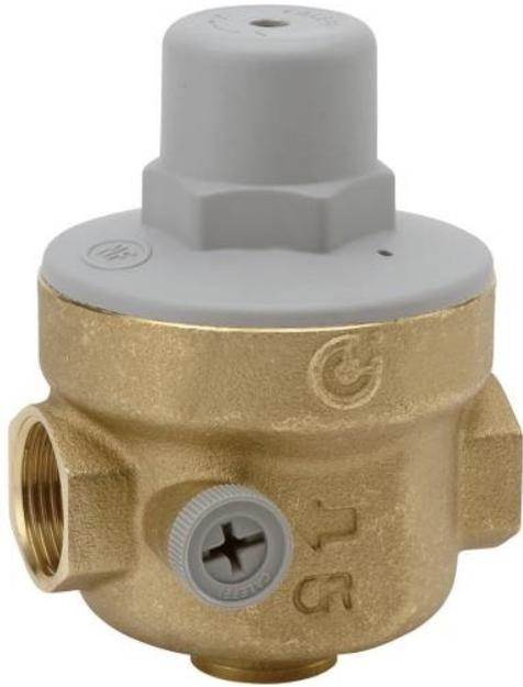
Pression amont maxi : 25 bar. Pression aval : 1 à 5,5 bar. Livré pré-taré: 3 bar. Température maxi : 80°C. Livré sans raccord.
