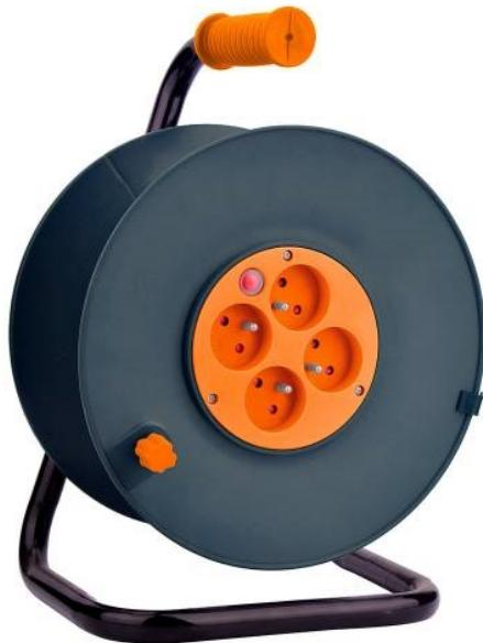
Enrouleur de bricolage équipé de 4 prises 2P+T 16A et d'un coupe circuit thermique. Non câblé et prévu pour une capacité de 40m en HO5VV-F 3G1,5mm<sup>2</sup> avec platine fixe. Poignée ergonomique. Tambour plastique. Solide grâce à son socle en métal. Puissance max déroulé 3000W et enroulé 800W sous 230V~.
