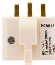
Fiche DCL à connexion par borne à vis pour conducteur de 0,5 à 1mm<sup>2</sup>. Fonctionne en 6A sous 250V~ sur fiche 2'+T. Connexion par borne à vis.
