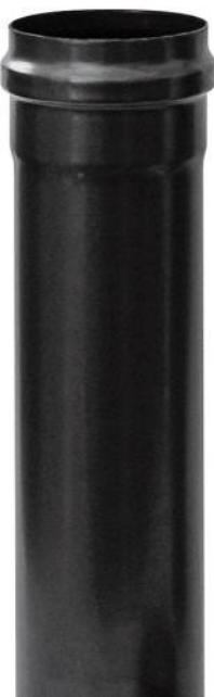
Tôle émaillée de 0,80mm d'épaisseur. Emboîtement de 50mm. Joint d'étanchéité de silicone inclus (classe d'étanchéité P1 200 Pa). Recoupable côté mâle.
