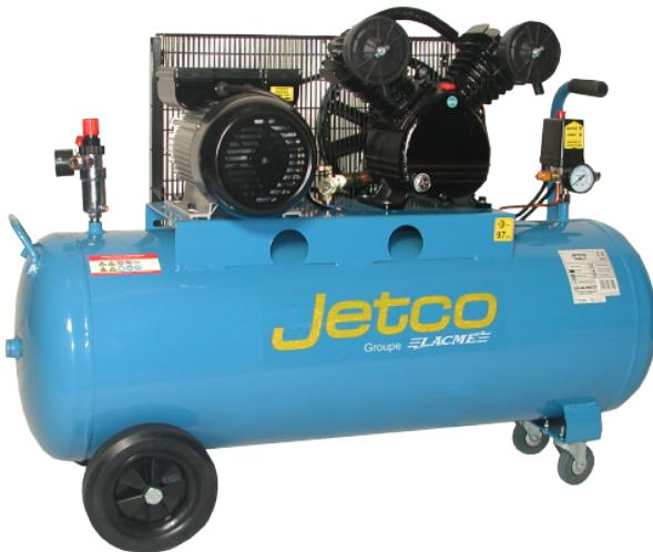
Groupe bicylindre en V fonte monoétage. Epurateur détendeur avec 2 sorties dont 1 raccord rapide. Sortie directe raccord rapide. Manomètre 12 bar pour indiquer la pression de la cuve. Contacteur manométrique. Clapet anti-retour. Soupape de sécurité. Robinet de purge. Poignée de manutention. Roues pleines Ø 200 mm. Roues directrices avant.
