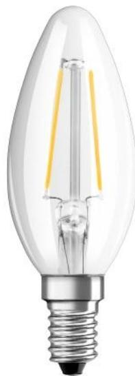
Lampes avec technologie de filament LED innovante. Conception, dimensions, flux lumineux comparables à une lampe à incandescence classique ou halogène. Pas d'émission d'UV ni d'IR dans le faisceau lumineux. Allumage instantané. Peut remplacer facilement les lampes standard. Puissance thermique plus faible (par rapport au produit de référence standard). Non gradable. Classe d'énergie efficace : F.
