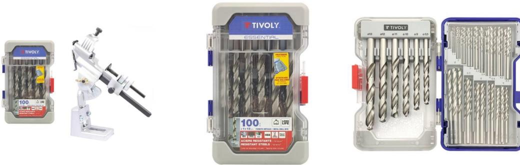
Coffret de chantier en matière 100% recyclable, renforts périphériques antichoc comprenant 100 forets HSS taillé meulé pour le perçage des aciers et des aluminiums allant de 1 à 13mm ainsi qu'une affûteuse. Perçage aisé grâce à l'affûtage auto centrant pointe en croix. Usage polyvalent. Queue cylindrique. Goujure type N à 30°. Pointe 118°.
