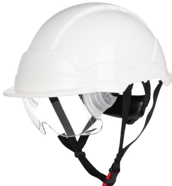
Casque de sécurité Phoenix Pro. Coiffe en ABS, harnais en polyéthylène 6 points avec 6 bandeaux textile, réglage par crémaillère de 52 à 63cm. Visière courte, lunettes de sécurité intégrées avec traitement anti-rayure et anti-buée. Fentes latérales, basane en textile 3D, jugulaire 4 points fournie avec le casque. Poids 450g.
