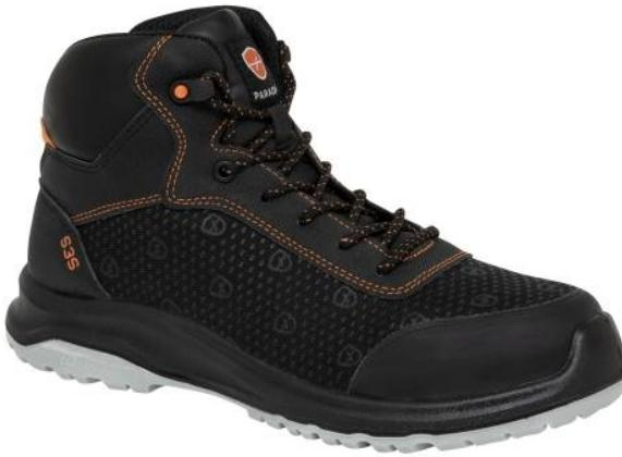
Dessus technologie Xtra Shield One, hydrofuge et résistante à 36000 cycles d'abrasion (Atteint les résultats sur l'abrasion imposés par la norme gants EN388 niveau de perf. 4/4). Renfort avant TPU, doublure Mesh 3D. Embout composite, semelle anti-perforation textile PS. Semelle en polyuréthane bi-densité flexible Be-Flex. Première de propreté ultra-confortable haute résilience. Chaussure amagnétique.
