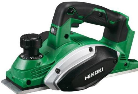
Grande capacité de coupe (profondeur jusqu'à 2mm et feuillure jusqu'à 9mm). Réglage facile et précis de la profondeur. Compact et ergonomique poignée soft-grip. Cale rétractable pour éviter aux lames d'être en contact sur le support. Évacuation des copeaux sur le côté. Chargeur ventilé pour optimiser l'utilisation des batteries. En option : possibilité d'orientation des évacuation avec un raccord coudée et possibilité fixation sac à poussière ou raccordement à un aspirateur.
