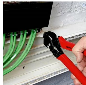
Pince spéciale pour découper des encoches dans des plinthes et boîtiers en plastique dans le domaine de l'installation électrique et sanitaire. L'encoche peut être agrandie à volonté en coupant plusieurs fois. Bords de coupe nets, le profil découpé ne nécessite aucune finition. Manipulation facile. Avec ressort d'ouverture, limitation d'ouverture et système de verrouillage. Poids 414g.
