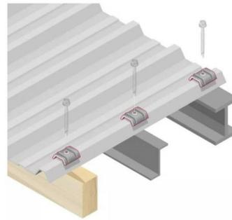
Gain de temps grâce à sa rondelle prémontée. Cavalier en acier galvanisé prélaqué.
