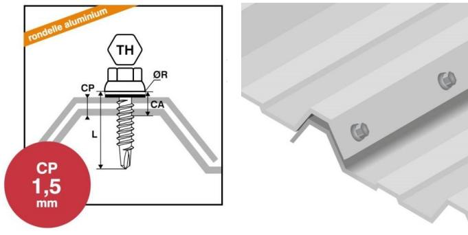
La vis autoperceuse TH se pose en plage en accord avec les spécifications du DTU 40.35. X-TremcoatC2 / 15 cycles. Z-forcehead / 20 ans.
