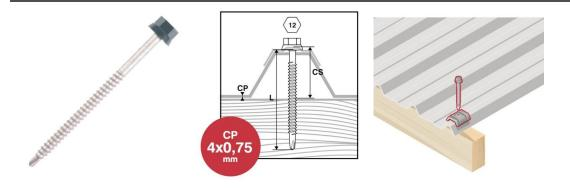
La vis autoperceuse TH se pose en sommet de nervure en accord avec les spécifications du DTU 40.35. Elle doit être posée avec un support de répartition. En sommet de nervure: avec le cavalier adapté au type de nervure.X-TremcoatC2 / 15 cycles. Z-forcehead / 20 ans.
