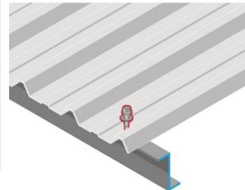
La vis autoperceuse TH se pose en plage en accord avec les spécifications du DTU 40.35. X-TremcoatC2 / 15 cycles. Z-forcehead / 20 ans.
