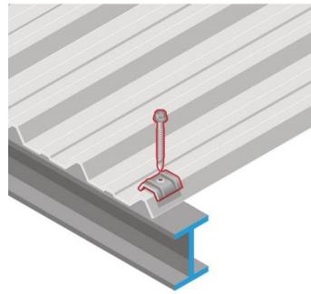
La vis autoperceuse se pose en sommet de nervure en accord avec les spécifications du DTU 40.35. Elle doit être posée avec un support de répartition. En sommet de nervure: avec le cavalier adapté au type de nervure. X-TremcoatC2 / 15 cycles. Z-forcehead / 20 ans.
