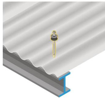
La vis autoperceuse TH avec rondelle d'étanchéité se pose en plage en accord avec les spécifications du DTU 40.37. Hauteur mini 67mm.
