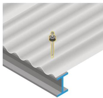
La vis autoperceuse TH avec rondelle d'étanchéité se pose en plage en accord avec les spécifications du DTU 40.37. X-TremcoatC2 / 15 cycles.
